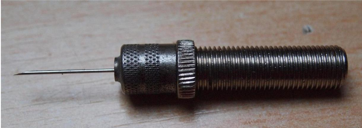
Nadeladapter auf Autoventil zum befüllen der IFP Kammer
