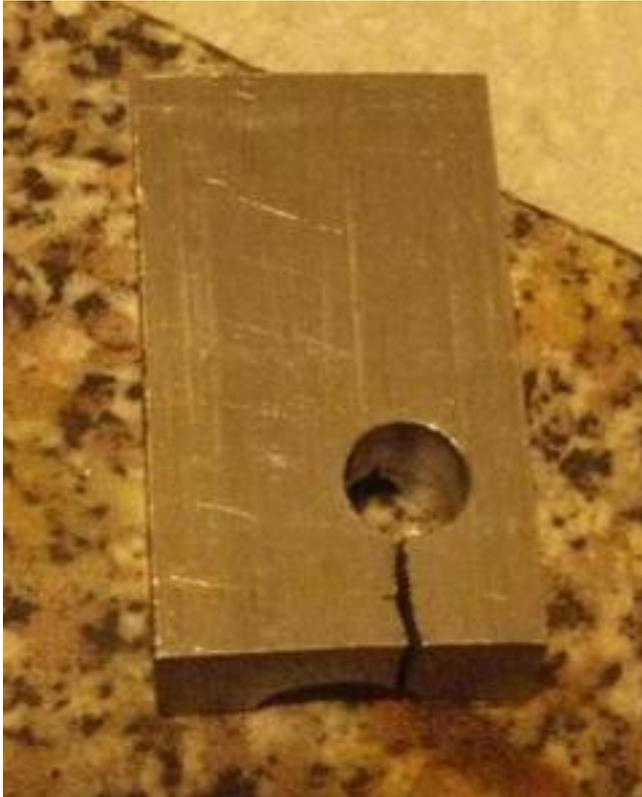
Klemmblock für Kolben (Float CTD benötigt 9mm), beim Triad benötigt man 2 teiligen Klemmblock
