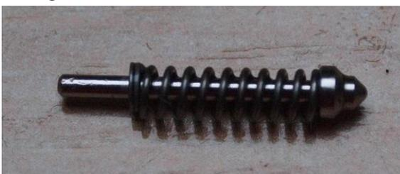
Die Einbuchtung im Kunststoffteil zeigt nach oben im Kolben, also entgegen der Stickstoffkammer. Damit die Schraube am Ende vom Piston Assembly darin Platz hat.
