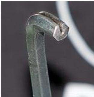
Geschlitzter Inbusschlüssel (etwas lang, die Nadel muss dann unnötig lang sein)
