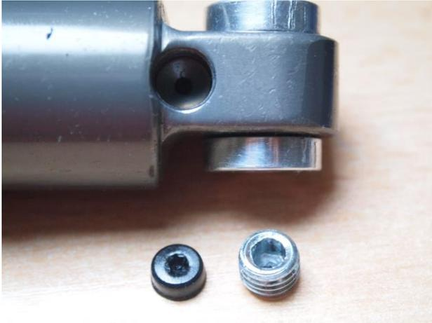
5. Das untere Dämpferauge spannt man nun samt Dämpferbuchsen in einen Schraubstock mit Schonbacken. Die 5/64" Madenschraube oben etwas lösen um evtl. vorhandenen Restdruck entweichen zu lassen. Unter dieser Inbusschraube ist eine kleine 3.14mm Kugel die man nicht verlieren sollte. Man sieht diese besonders gut an der Unterseite silbern durchschimmern.
