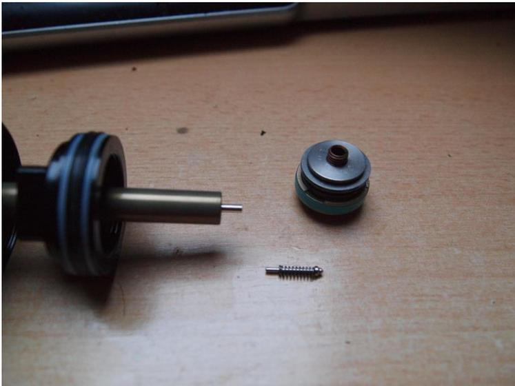
Acht geben damit keine Teile verloren gehen und man den Shimstack (siehe Anhang) im Piston Assembly nicht durcheinander bringt. Diese Teile an einen Ort stellen wo nichts auf den Boden fallen kann. Der Gleitring auf dem Piston Assembly sollte einen Aussendurchmesser von 23.80mm aufweisen. Der Durchmesser von der Metallnut daneben beträgt 23.46mm.
