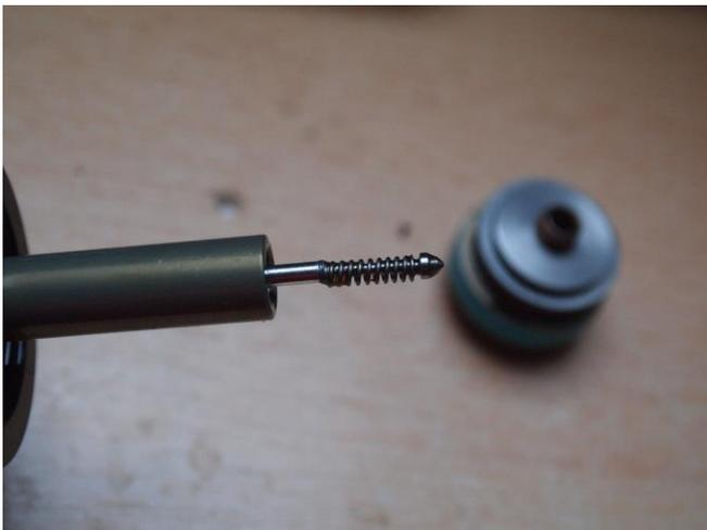
16. Nun noch das Ventil mit dem 10er Ringschlüssel auf 5Nm festziehen. Und es sollte so wie auf dem Foto unten aussehen.
