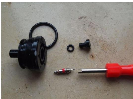
Neues Ventil (1.1Nm) und 2 O-Ringe samt Verschlusschraube sind in der IFP Baugruppe enthalten. Wenn die Verschlusschraube beim öffnen ploppt, ist das noch kein Hinweis auf ein defektes Ventil. Diese sind auf Dauer leider nicht 100% dicht.
