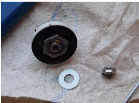
Hier im Bild oben der 13x.12 Shim vom Rückschlagventil zu sehen. An der Innenseite der Hohl-schraube befinden sich 2 Rebound Shims mit 13x.15. Fehlen die Rebound Shims, funktioniert der Lowspeed Zugstufenregler nicht, weil es einen Bypass über die Highspeed Shims gibt! Fehlt der Shim fürs Rückschlagventil würden sich LSR und LSC gegenseitig verstellen, da das Öl den falschen Weg nimmt.
