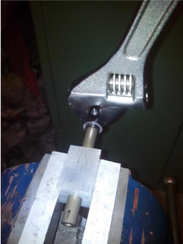
11. Dämpfergehäuse einspannen und IFP Abdeckung abschrauben mit Rock Shox Pin Spanner, dabei unten mit 30mm Konusschlüssel gegenhalten
