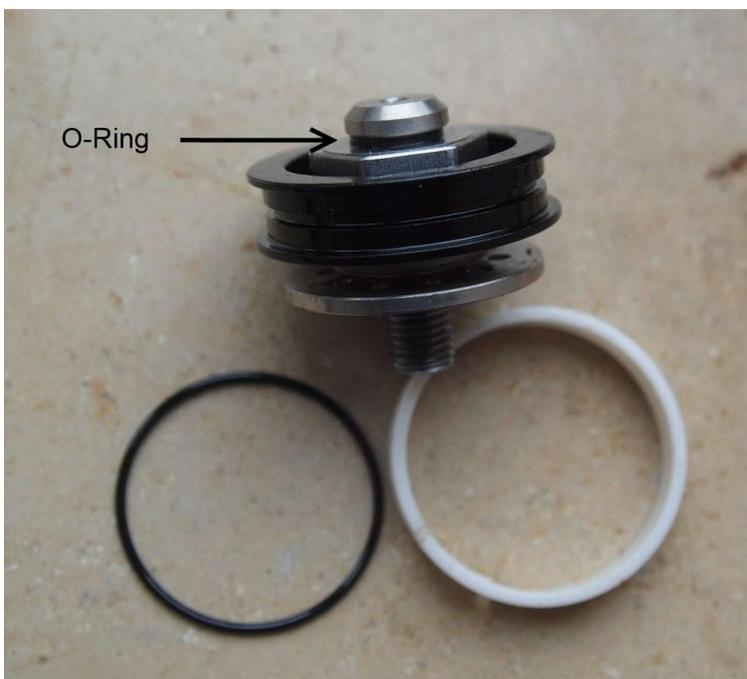
Die 3 Dichtungen im Service Kit sind nicht sofort erkennbar. Der große O-Ring sitzt unter dem weißem Gleitring und der 6mm O-Ring ist oben zu ersetzen, wenn man die Schraube mit dem 2mm Inbus öffnet (Vorsicht, der Schlüssel rutscht leicht durch). Darunter befindet sich 1 Shim 13x.12 für das Rückschlagventil.
