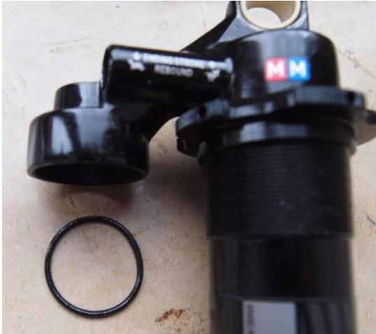
Leicht zu übersehen, im Gehäuse wird der O-Ring ersetzt der in den IFP Teilen enthalten ist.
