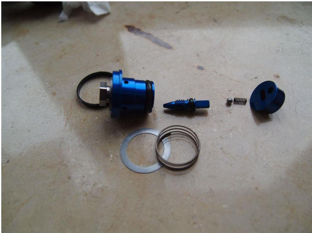
Der Kunststoffring links ist im Service Kit nicht enthalten. Statt dessen gibt es einen O-Ring, den ich aber nicht verwendet habe. Desweiteren sind 2 O-Ringe, Check Shim, Feder und Kugel im Service Kit. Die Nadel lässt sich einfach mit der Hand herausdrehen. Beim einsetzen der Einheit diese mit 2 Finger zusammendrücken und dann im Dämpfergehäuse einsetzen. In der Einheit stecken noch 2 16x0.2 und 2 16x0.15 Shims sowie 4 8x0.20 Shims die fest verschraubt sind.
