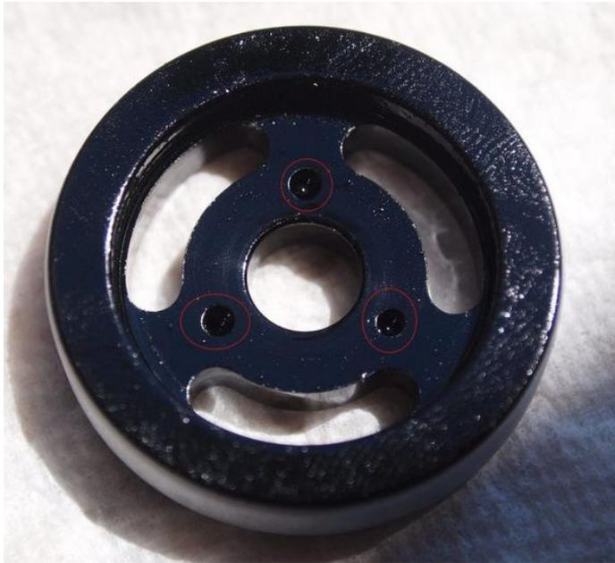
Diese 3 Löcher werden durch die 2 oben genannten Rebound Shims verschlossen.
