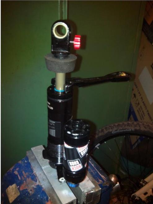
4. Innersleeve mit rotem Aluteil und schwarzen Plastikring an Unterseite aus Hauptkammer entnehmen
