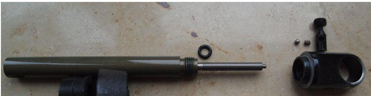
Vorne am Gewinde sitzt ein O-Ring der das Eyelet dichtet, des weiteren werden die Kugel und Feder im Eyelet ersetzt. Bei der Nadel im inneren der Kolbenstange muss normalerweise nichts gemacht werden, bei mir befanden sich dort jedoch Reste eines O-Rings die dort nicht hingehören. Beim zusammenbau erst den Einsteller montieren.
