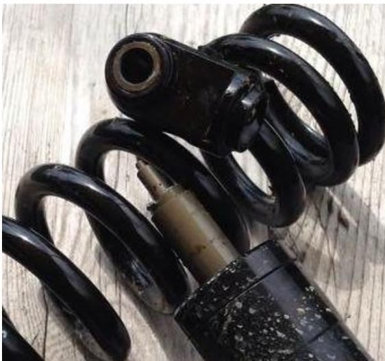
Abgerissene Kolbenstange, evtl. weil Eyelet zu schwach festgeschraubt war und dadurch Bewegungen an der Verschraubung entstehen können.
