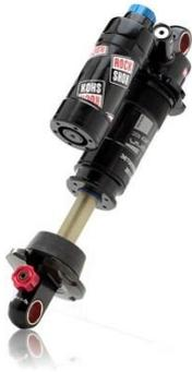
Der Service sollte bei diesem Modell rechtzeitig durchgeführt werden, da die gleiche verschleissintensive Buchse wie bei den Dämpferbuchsen verwendet wird. Ist die rote Schicht abgerieben, reibt Metall auf Metall und die Kolbenstange geht defekt. Ein ähnliches Problem wie bei den Dämpferbuchsen, was sich durch Kunststoffgleitlager vermeiden ließe. Der Seal Head ist leider nur im Kit erhältlich und die Dichtungen lassen sich auch nicht einzeln wechseln.
