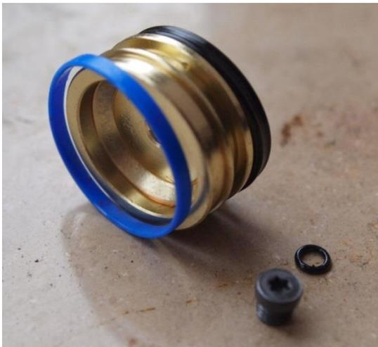
Der blaue Kunststoffring und der Quadring, sowie die Entlüftungsschraube samt O-Ring sind zu ersetzen.
