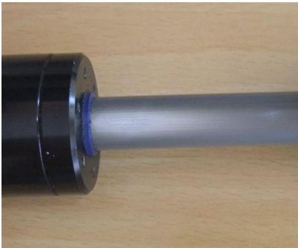
Die Kolbenstange sollte ersetzt werden falls sie so aussieht
