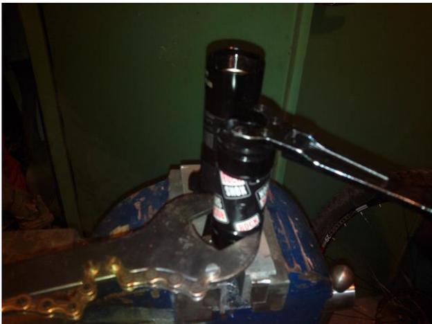
12. IFP Gehäuse mit 30mm Schlüssel abschrauben, Achtung hier ist noch etwas Öl
