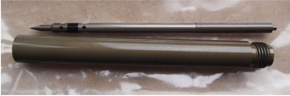
Hot Rod Adjuster Needle, der schwarze Teil ist thermoelastisch und dehnt sich bei Hitze aus so das die Nadel länger wird (Normallänge 113.3mm).
