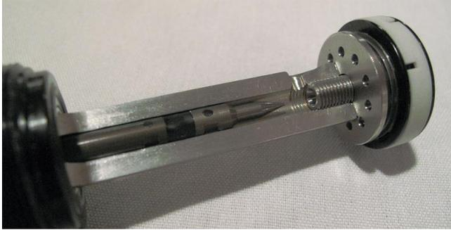
Im oberen Bild sieht man die Funktion vom Rebound Einstellknopf. Die durch den Einsteller seitlich verschiebbare Hotrod Nadel drückt es gegen den Main Piston.
